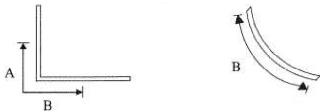
شکل ۳-۱: تفاوت خم شدن میلگرد بر اساس نقشه کشی و در عمل
